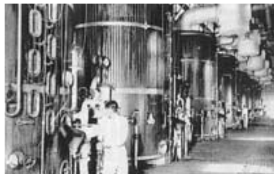
▲近代製糖會社規模龐大的結晶罐。（圖片提供／央圖臺灣分館）
