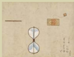
玻璃製沙漏鐘（測量航海距離）
